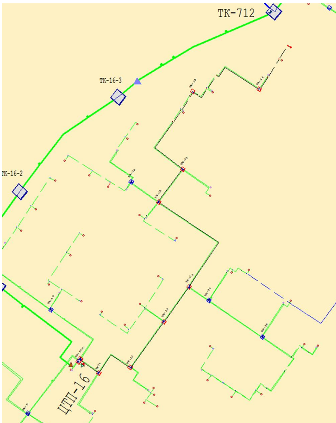
Рисунок 3.6 – Трассировка теплопровода от обобщенного потребителя «ЦТП-16» до конечного потребителя «Сазонова,14а-01» (вторая часть расчетного пути 1-2)
